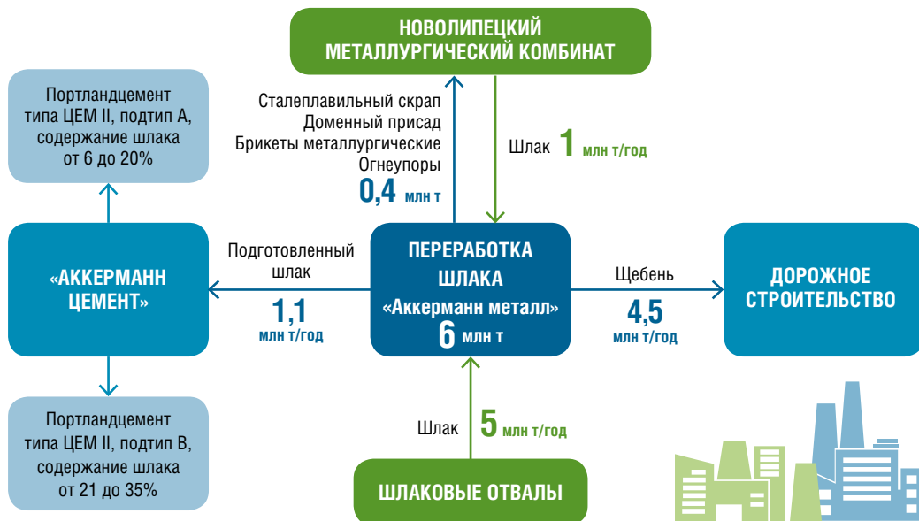
Рисунок. Внедрение НДТ и вовлечение накопленных металлургических шлаков в производство в АО «Аккерманн цемент»
