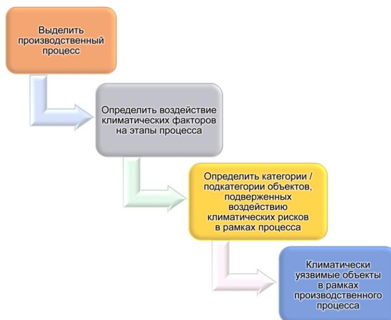
Рисунок 1. Схема подхода по идентификации климатически уязвимого объекта в рамках производственного процесса Figure 1. Schematic diagram of the approach to identifying a climate vulnerable object within the production process
