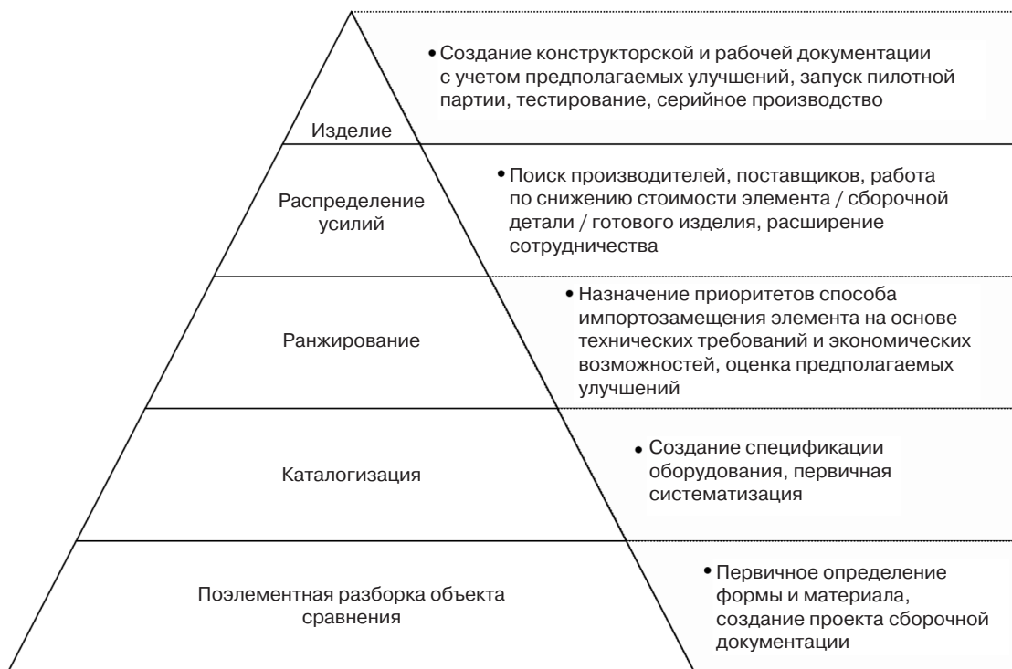
Рис. 5. Иерархическая схема реверс-инжиниринга
