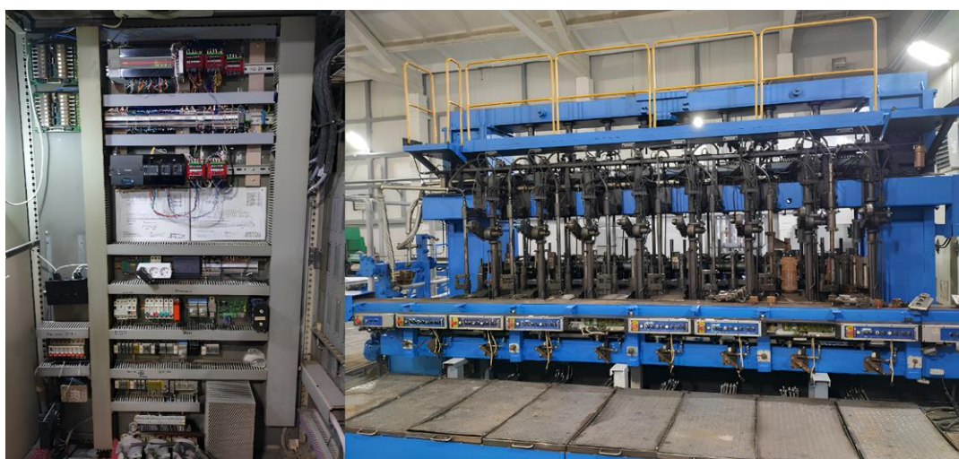
Рисунок 6 – Стенд для проверки алгоритмов программ управления механизмами секций, функционирующий на площадке ООО «Красное «Эхо»
