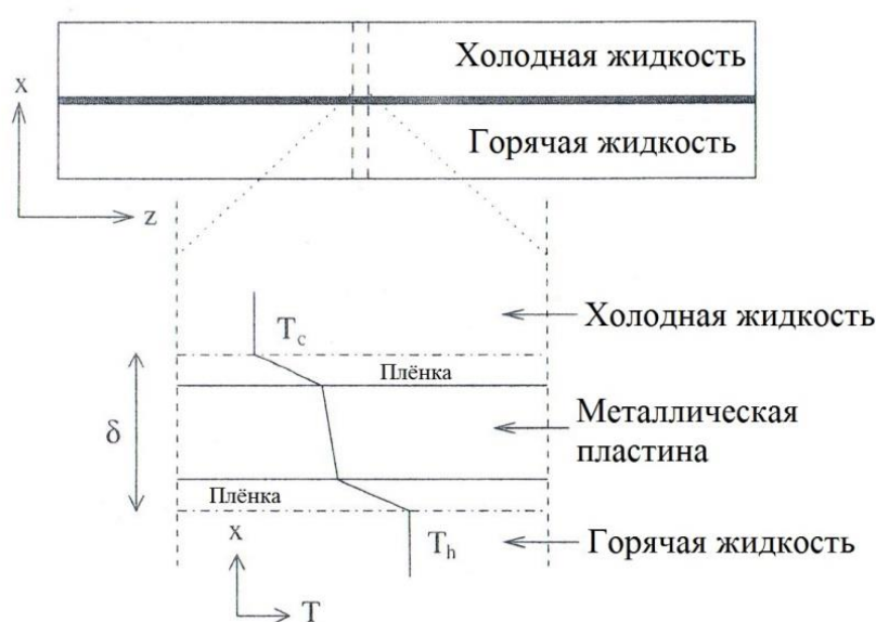
Рисунок 11.3 – Схематическое изображение теплообменника. Термическая движущая сила взята поперёк \delta – толщины металлической пластины и прилегающих слоёв.
