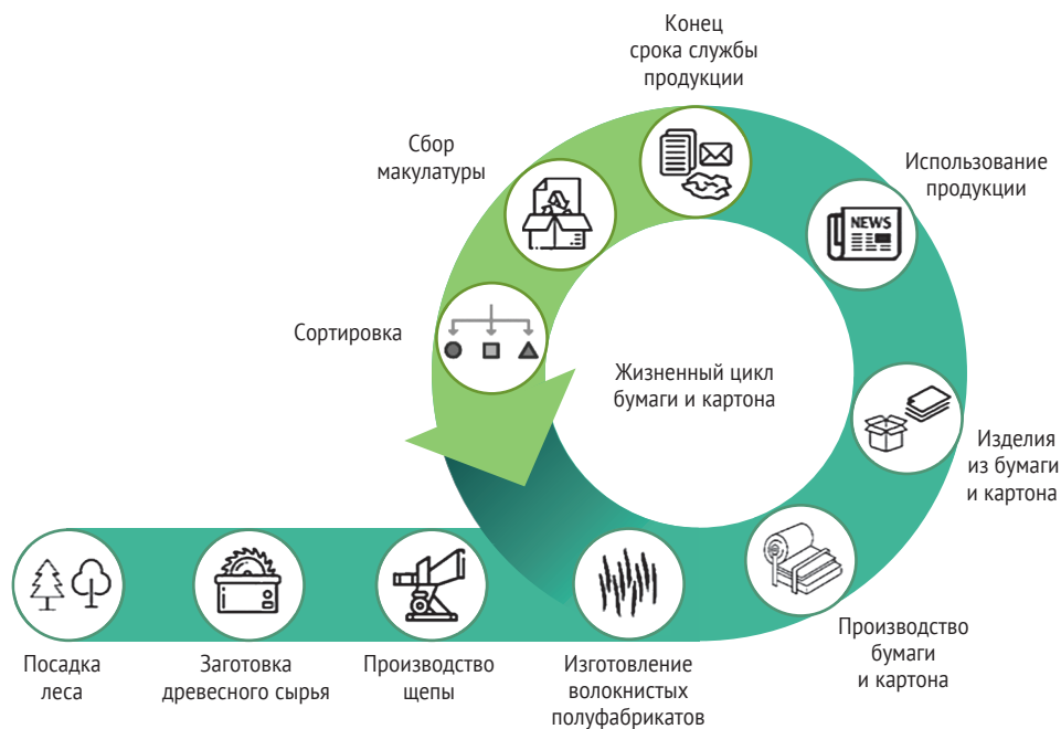
Рис. 14. Схема жизненного цикла бумаги и картона
