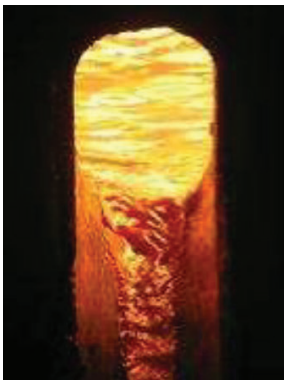
Рис. 34. Вид сверху летки, заполненной плавом (презентация фирмы Metso)
