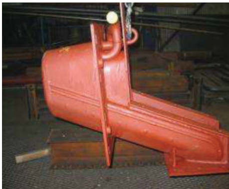
Рис. 33. Вид сбоку летки плава (презентация фирмы Metso)
